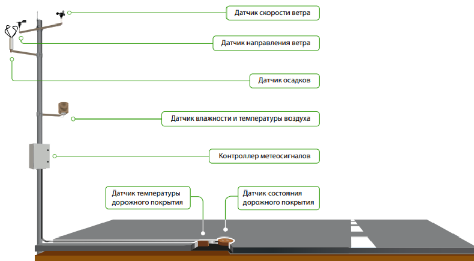
Рис. 1. Основные датчики автоматической дорожной метеорологической станции
